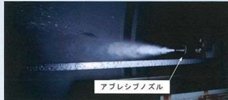
写真3 噴射状況（2液混合）
