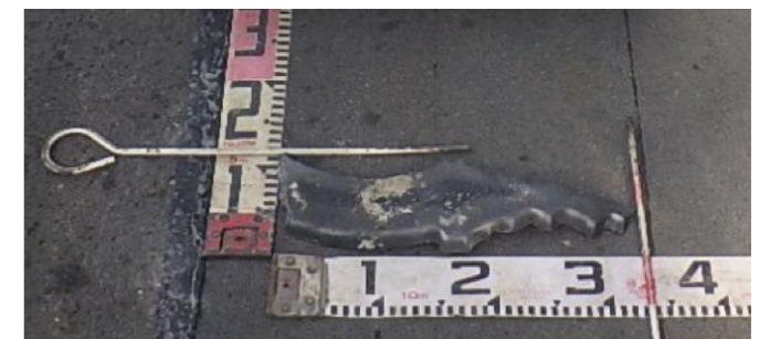
写真-4 鋼矢板Ⅲ型 回収状況
