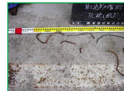
写真-2 RC杭鉄筋回収状況
