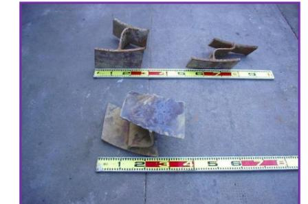
写真-3 H形鋼-250回収状況
