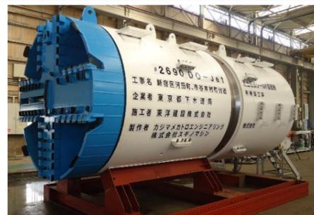
写真-1 本工事で使用した掘進機
