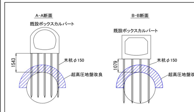
図-3 地盤改良概要図
