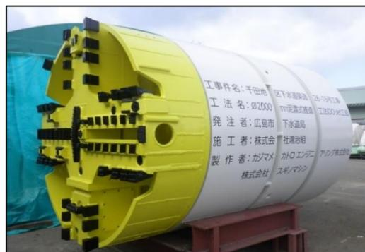
写真-1 本工事で使用したDO-Jet掘進機
