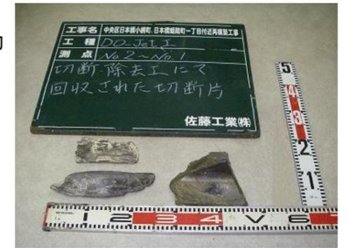
写真-1 H形鋼回収状況
