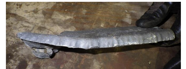
写真-4 ウォータージェット切断面
