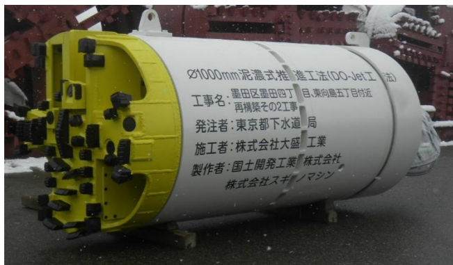
写真-1 本工事で使用したDO-Jet掘進機
