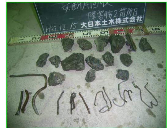
写真-1 RC杭切断片回収
