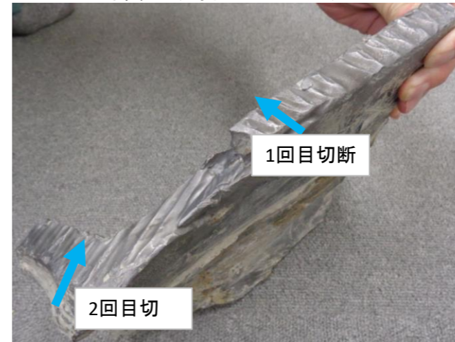
写真-1 超高圧ジェット切断面
