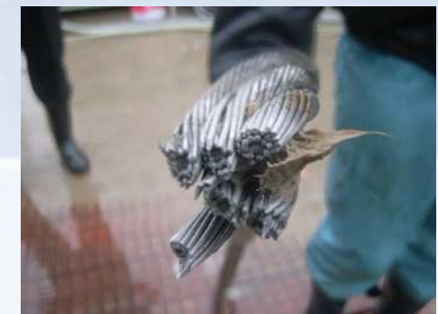
写真-3 ワイヤー切断面
