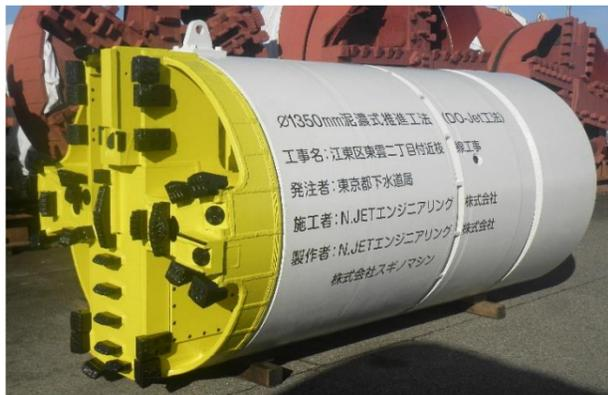
写真-1 本工事で使用したDO-Jet掘進機
