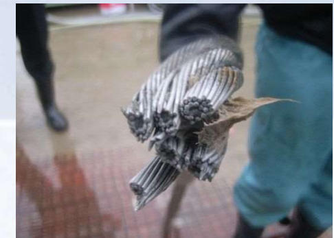
写真-3 ワイヤー切断面
