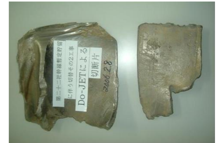
写真-1 切断除去したH形鋼(切断片)
