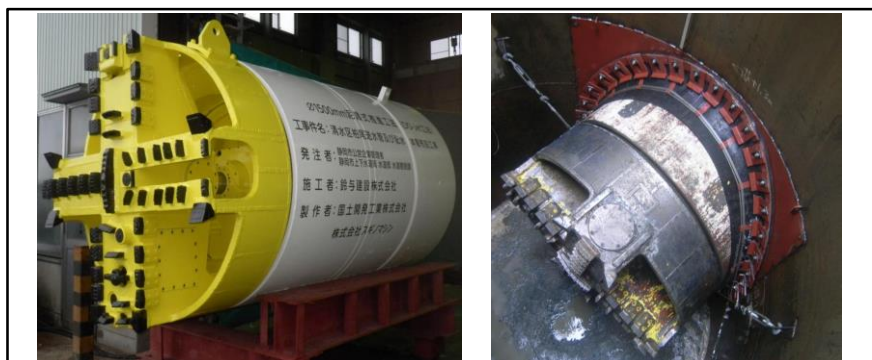
写真-1 DO-Jet掘進機
